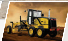
BG605I Motor Grader (FHP : 108kW)
